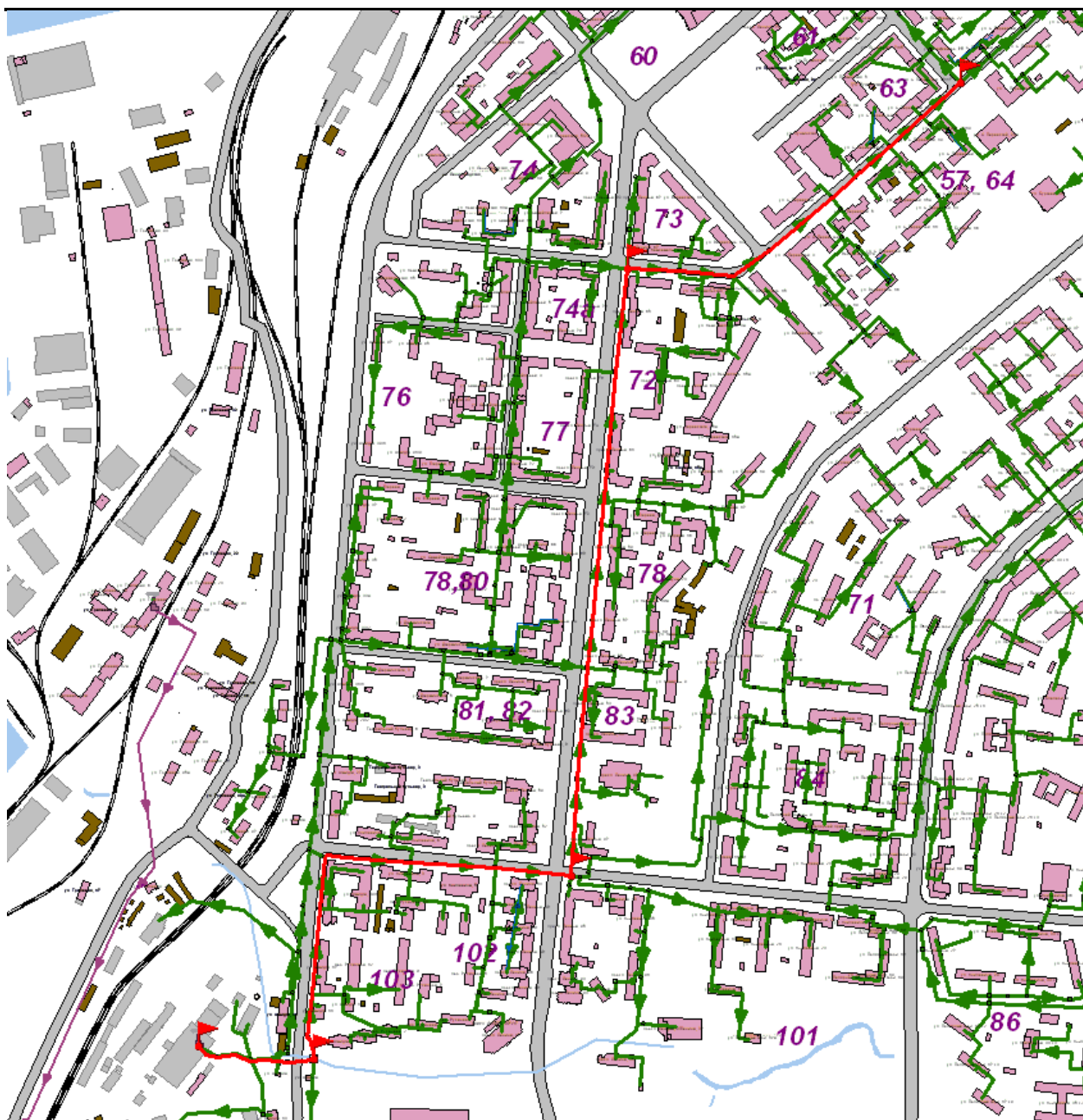
Рисунок 2. Схема прокладки тепломагистрали «Луч 2/1» Мурманской ТЭЦ
