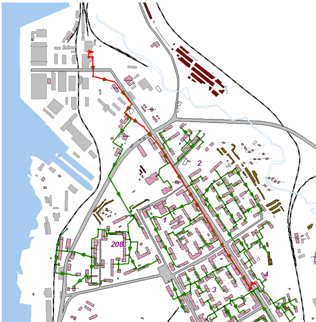
Рисунок 8 – Схема прокладки магистрального вывода потребителям котельной РОСТА
