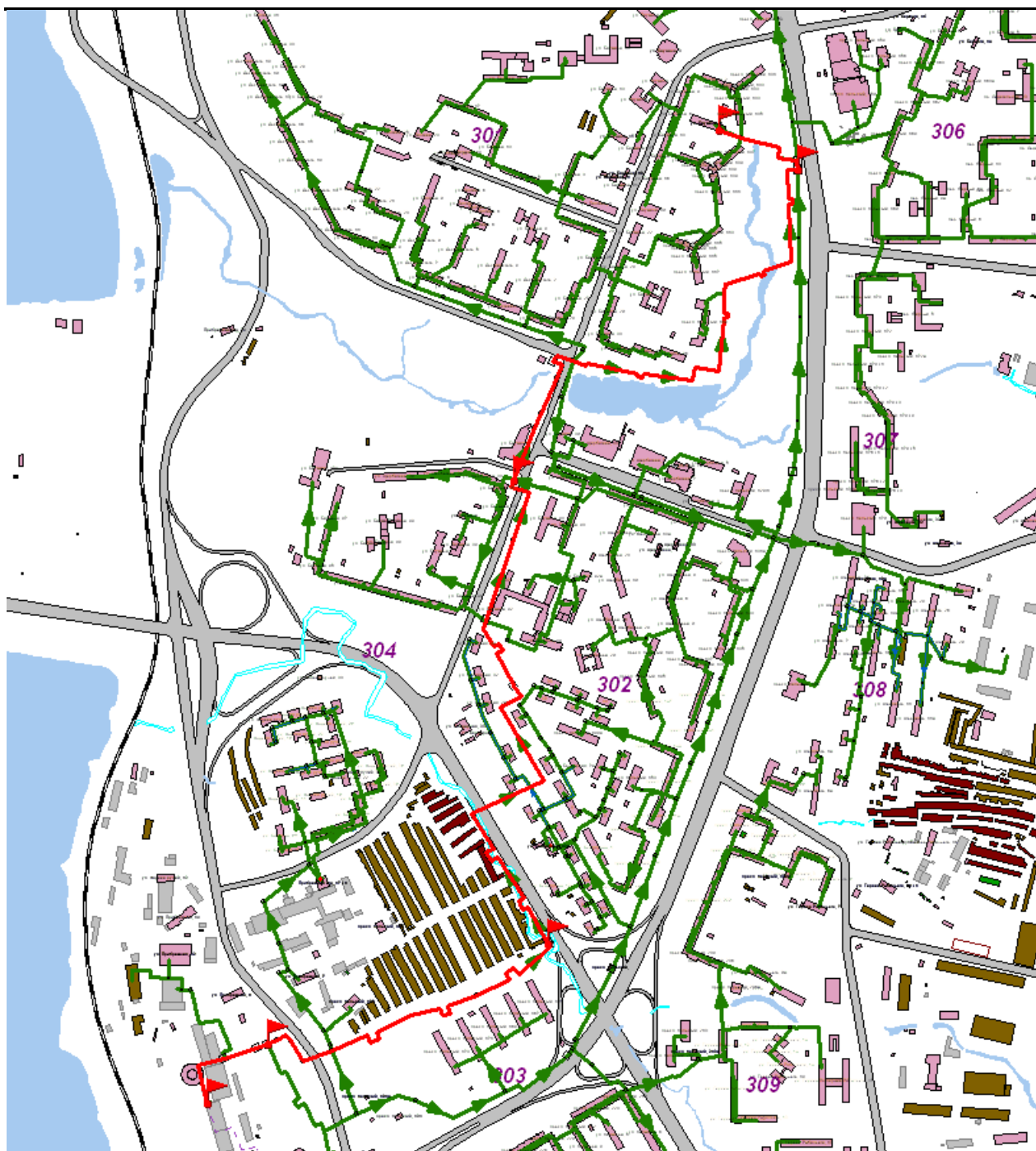
Рисунок 3 – Схема прокладки тепломагистрали «Луч 1» Южной котельной
